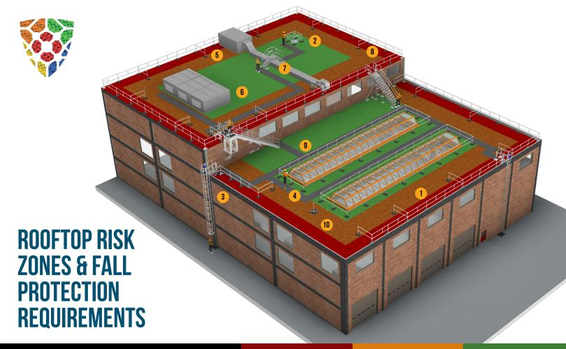
**GUARDRAILS WITH TOE-BOARDS**
